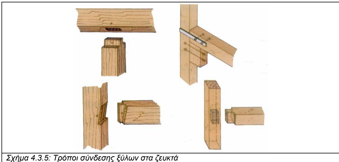
Σχήμα 4.3.4: Τρόποι σύνδεσης ξύλων στα ζευκτά
